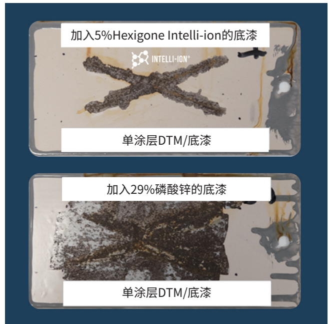
图1 ❖ Teamac公司在250小时加速老化实验后得出的结果 (ASTM B117)。
