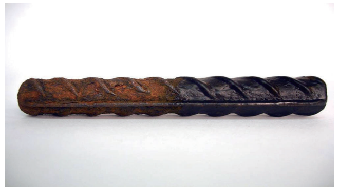
图3 ❖ 锈迹斑斑的钢筋，其中一半涂有防锈转化底漆。
