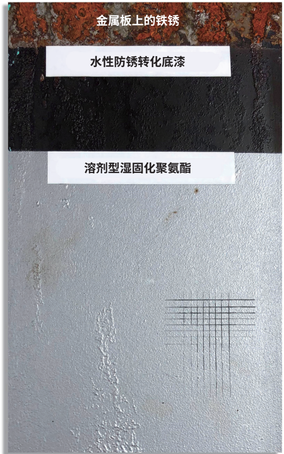
图2 ❖ CorrVerter用于带聚氨酯面漆的生锈钢板。
