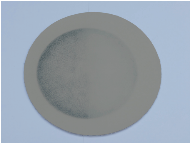
示例1, 传统自消光PUD的EMPA 128/1测试结果。左半部分为清洁前, 右半部分为用清洁肥皂溶液清洁后。
