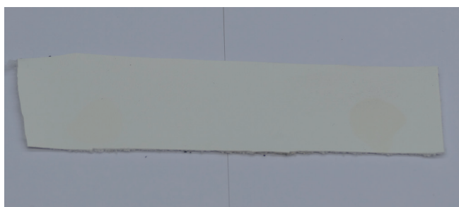
示例6, 用清洁肥皂溶液清洁后, LANXESS新面漆上的咖啡污渍(左侧1小时后, 右侧24小时后)。
