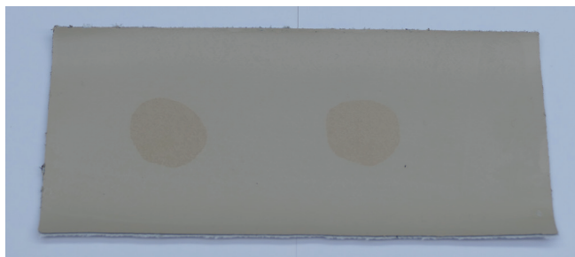
示例4, 用清洁肥皂溶液清洁后, 常规自消光PUD上的咖啡污渍(右侧1小时后, 左侧24小时后)。
