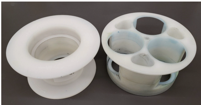
图2 ❖ 样品托双轴离心机（三个用于研磨，一个用于测涂料着色强度）。
