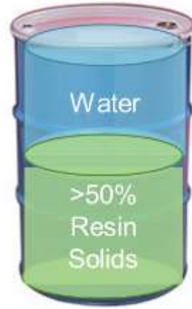
High Solids PUD
