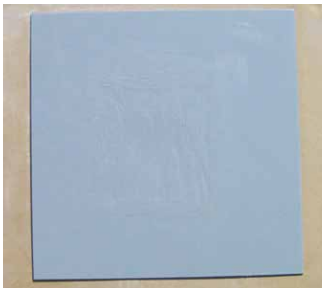
图 12 ❖ 用热固化2K环氧涂料修复涂层。
