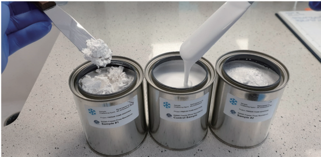
图7 ❖ 三次冻融循环后含TPnB的涂料（左）和参考样（中）。
