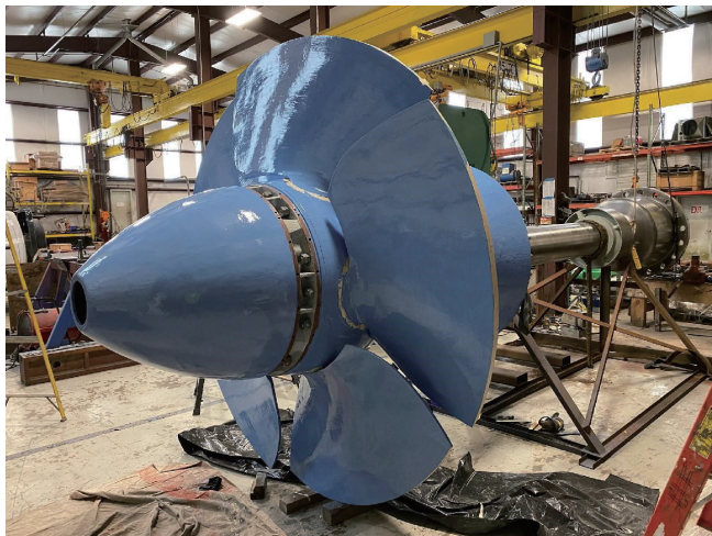
Belzona 1111 (Super Metal) 和Belzona 1341 (Super Metal Glide) 应用后组装的水电机组。
