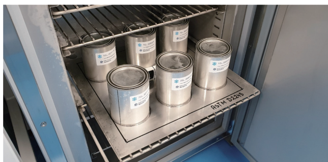
图2 ❖ 1品脱（16 fl. oz.）罐内的涂料在一次冷冻循环后取出。
