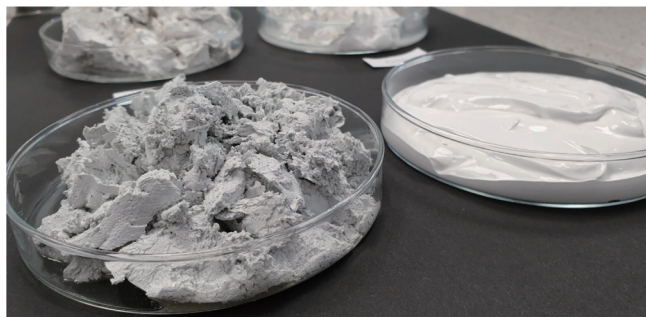
图1 ❖ 导致涂料缺陷的冻融具有各种凝结形式。
