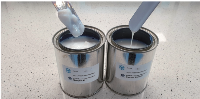
图 3 ❖ 三次循环后的聚合物乳液1号（左侧的样品）和参考样品（右侧）。
