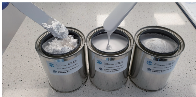
图 6 ❖ 三次冻融循环后含2-苯氧基乙醇的涂料（左）和参考样（中）。
