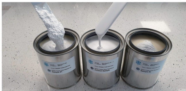
图 12 ❖ 三次冻融循环后，不含FTRA的基于乳液2号的涂料（左）和参考样（中）。
