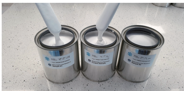
图 14 ❖ 三次冻融循环后，含3% FTRA的基于乳液2号的涂料（左）和参考样（中）。
