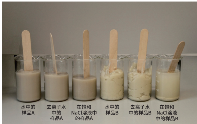
图4 电解质对5%水凝胶稳定性的影响（A：带状聚硅酸盐，B：层状硅酸盐）。
