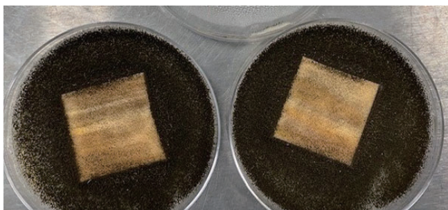
木器上未添加新型杀菌剂的PU涂层。
