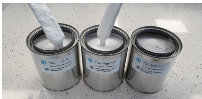
图 13 ❖ 三次冻融循环后，含1% FTRA的基于乳液2号的涂料（左）和参考样（中）。
