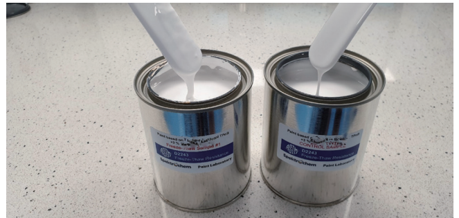
图10 ❖ 在三次循环后的含3% FTRA的涂料（左）和参考样（右）。
