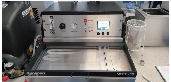
图 5 ❖ 根据ASTM D2354方法对含成膜助剂的聚合物乳液1号进行了MFFT测试。
