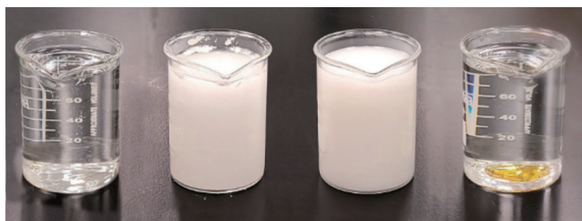
图 3 ❖ 与其他可能导致发黄、斑点或浑浊的杀菌剂相比，LapisShield对最终产品外观的光学影响最小。
