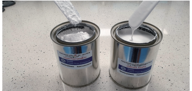
图9 ❖ 在三次循环后的含1% FTRA的涂料（左）和参考样（右）。
