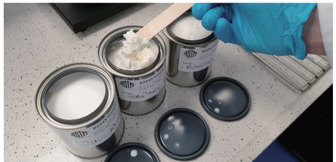
图 4 ❖ 三次循环后的聚合物乳液2号（完全失效，成为颗粒状）。
