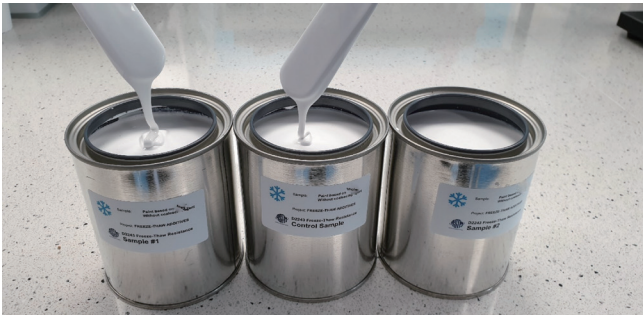
图8 ❖ 三次冻融循环后不含成膜助剂的涂料（左）和参考样（中）。
