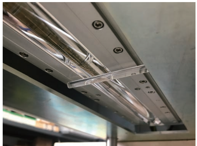
图9 ❖ ICAD在测量LED阵列时的照片。
