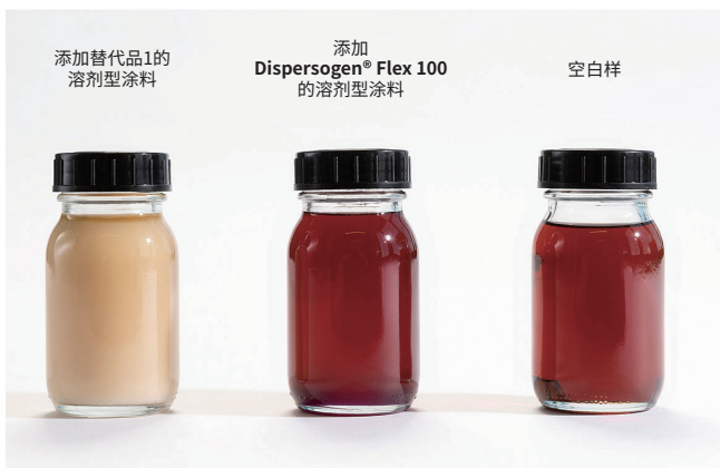
图 5 ❖ 分散剂和溶剂型体系的相容性试验。
