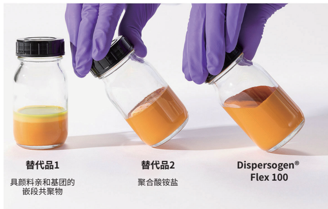
图1 ❖ 含有不同分散剂的颜料制剂在50°C下28天后的稳定性测试。
