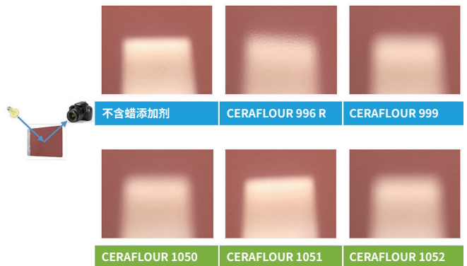
图7 ❖ 不含PTFE蜡添加剂1050,1051和1052在聚酯/三聚氰胺卷材涂层中的效果。
