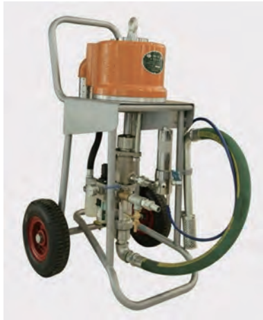
现有单管溶剂漆喷涂设备
