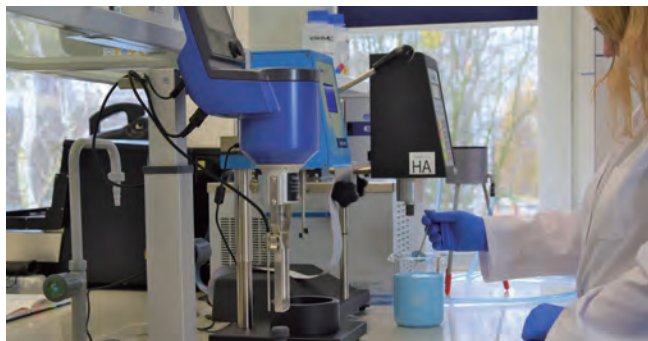
图3 ❖ Spektrochem原材料实验室用于测量低剪切粘度和中剪切粘度的实验室操作台。
