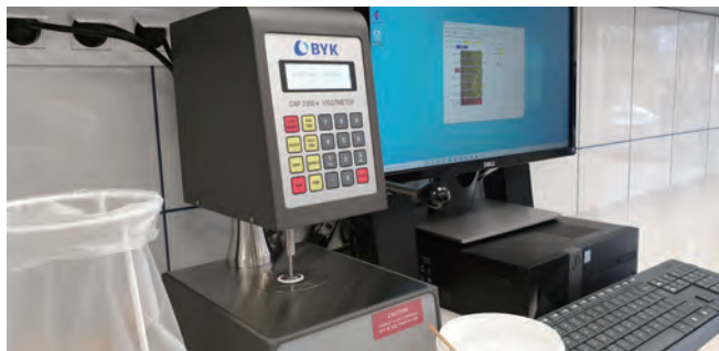
图4 ❖ Spektrochem实验室的ICI粘度计BYK CAP2000+（锥板）。
