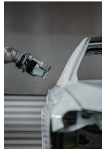
图3 ❖ 该系统的核心是涂敷器，它通过使用精密复杂的喷嘴来进行喷涂。
