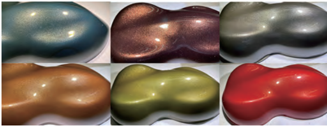
图5 ❖ 使用KinCoat颜料的汽车涂料样板。
