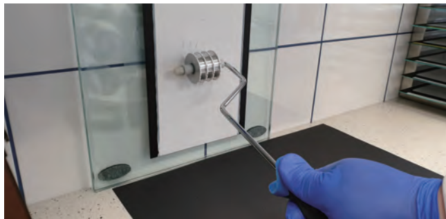
图8 在抗飞溅性能测试期间，在涂层上施加一个带切口的线轴辊筒。
