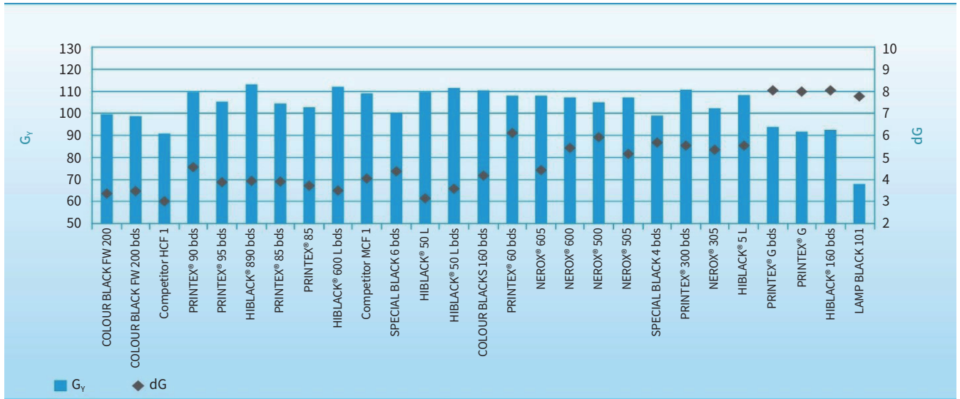
图3 羧基官能聚酯/HAA粉末涂层的灰度 (GY) 和底色 (dG)，二氧化钛与特种碳黑的比例为100:5。
