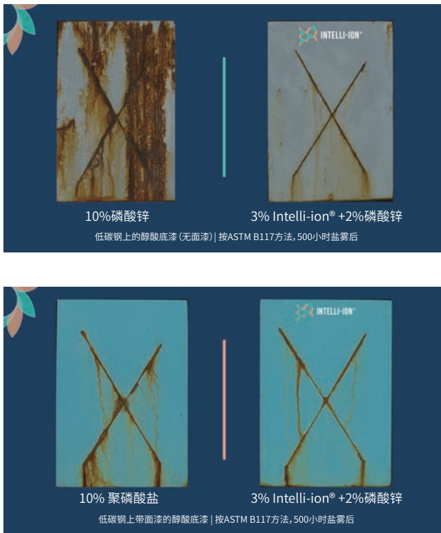
图 6-7 ❖ 磷酸盐基体系（左）与Intelli-ion（右）的工业标准盐雾试验（ASTM B117）结果。
